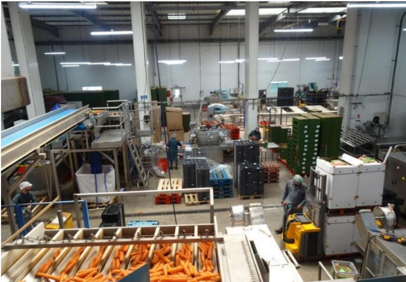
Le site de Créances du Groupe GPLM est appelé à concentrer le lavage des carottes. Il a été récemment doté d'un trieur optique qui permet d'optimiser la qualité du produit et d'homogénéiser in fine les lots. En 2022, la carotte au GPLM a représenté plus de 25 500 tonnes en 2022.
